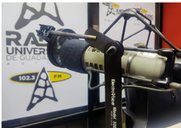
Figura 7. Micrófono profesional para radiodifusión, con cápsula de diafragma, supresión de ruidos y suavizador de golpe de aire, sin distorsión (cabina Radio Universidad Autlán).
