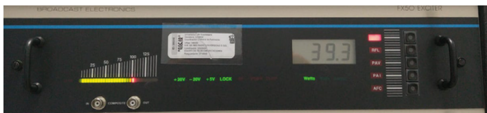
Figura 10. Vista frontal del preamplificador o excitador de 39 watts para el transmisor de potencia.
